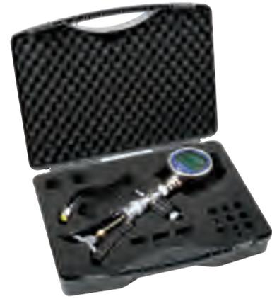
基本型号, 含气动式压力生成器
