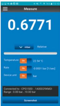
将app“myWIKa device”和WIKa-Wireless连接，CPG1500能够轻松地通过一部手机进行校准和日志程序配置。在压力测量过程中，数值能够直接以所需的单位显示在手机上。且可读取更多数据，如温度、压力变化频率。用户也可以从wika网站上检索更详细的设备信息。此外，该app允许配置、控制和保存日志程序。被保存在手机上的日志可以被转移到个人电脑上，通过wika-cal读取。
